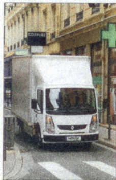
Renaults lille Maxity er en af de få 3500 kg varebiler med såkaldt frembygget førerhus, hvor motoren ligger under sæderne. Med frembygget kabine kan man køre med ti europaller og alligevel komme ned på en samlet total længde på 7,5 meter.
