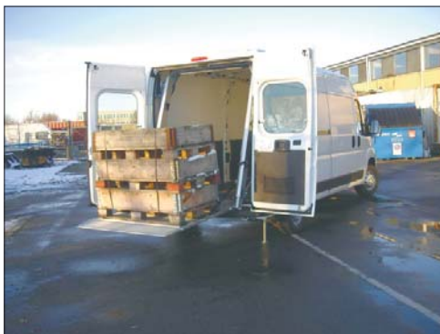
Kassebilens har den indbyggede Insiderlift, der kan klare 750 kg.
