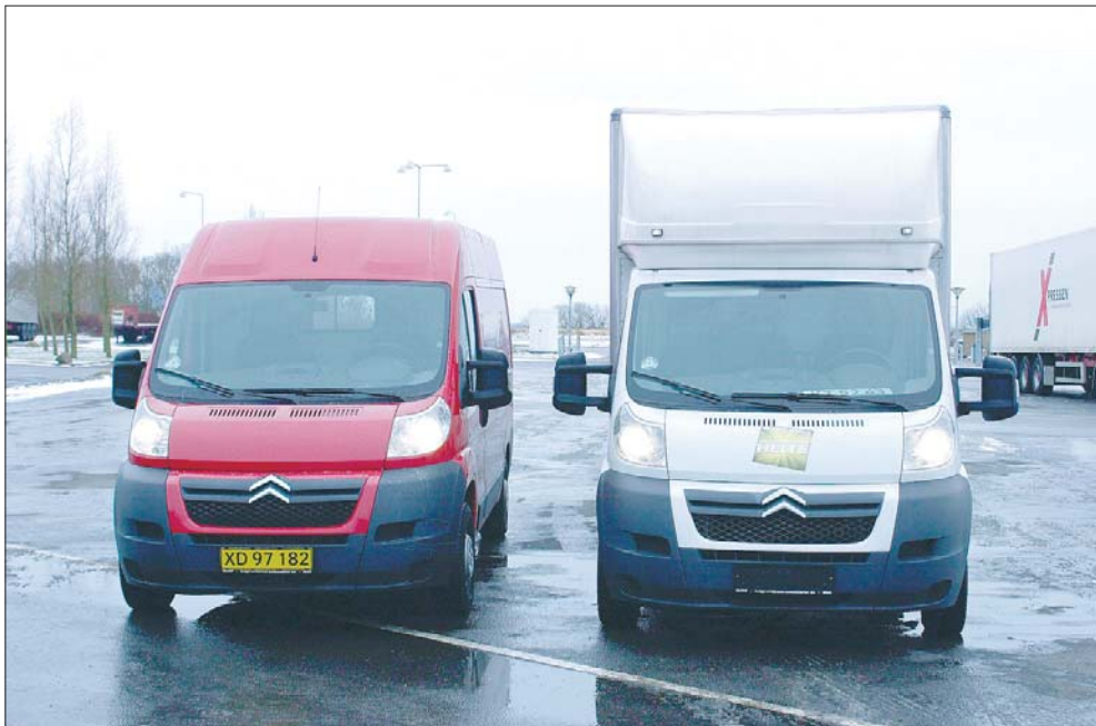
Citroen Jumper som kassebil (t.v.) og opbygningen med bokslad i duel mod hinanden. Kassebilen har bedre brændstofføkonomi, mens chassisopbygningen har mere plads.
