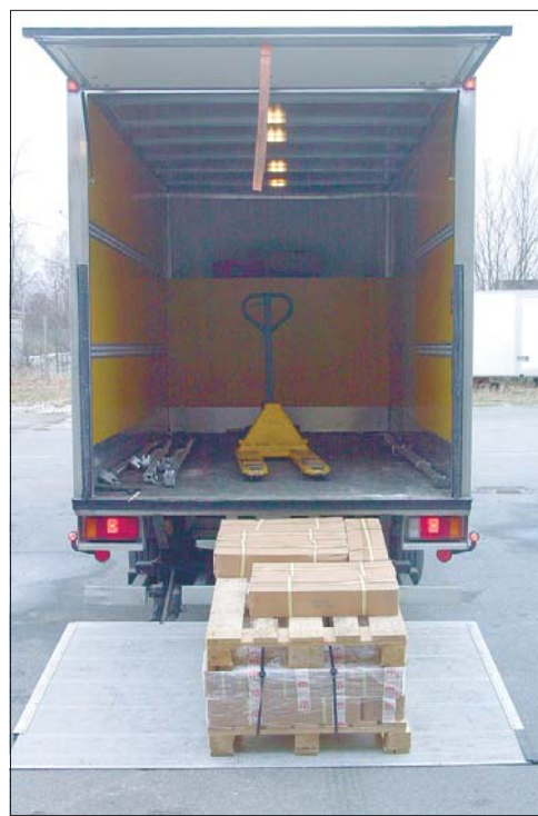
Chassisbilen med alu bokslad og en 750 kg Z-Lift.
