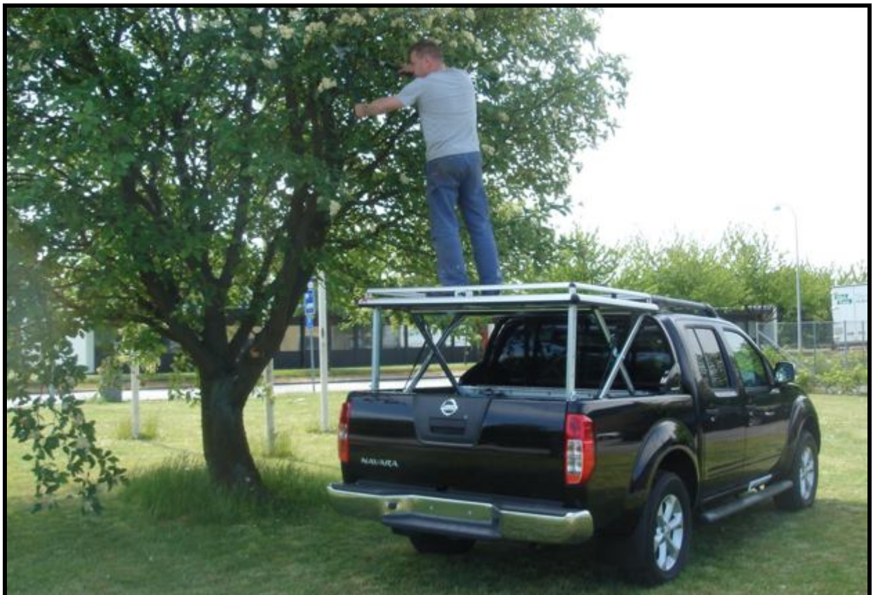
Kraftig konstruktion tillader at XTOP også kan bruges som arbejds platform (100 kg)
