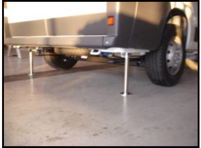
Hydrauliske støtteben forhindrer sammen-senkning ved pålæsning / aflæsning.
