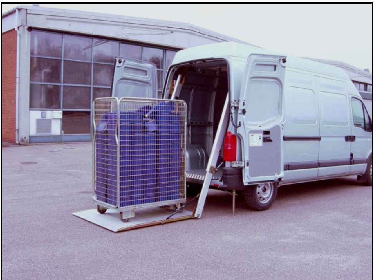
Meget lav opkørselsvinkel (1.4 grad) gør af / pålæsning til en leg.
