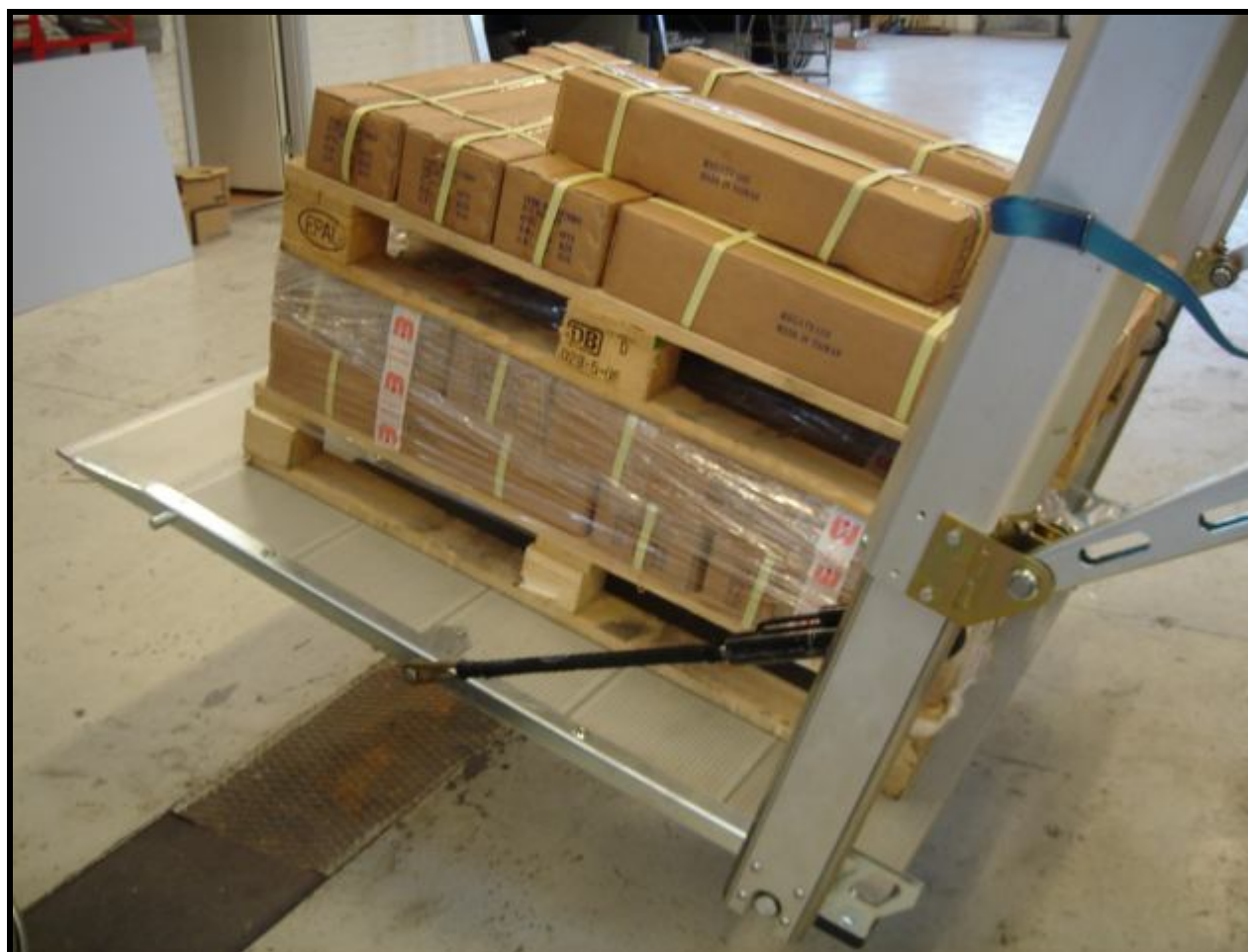
Hydraulisk vip af liftplade (+ 420 mm. / - 100 mm.)
