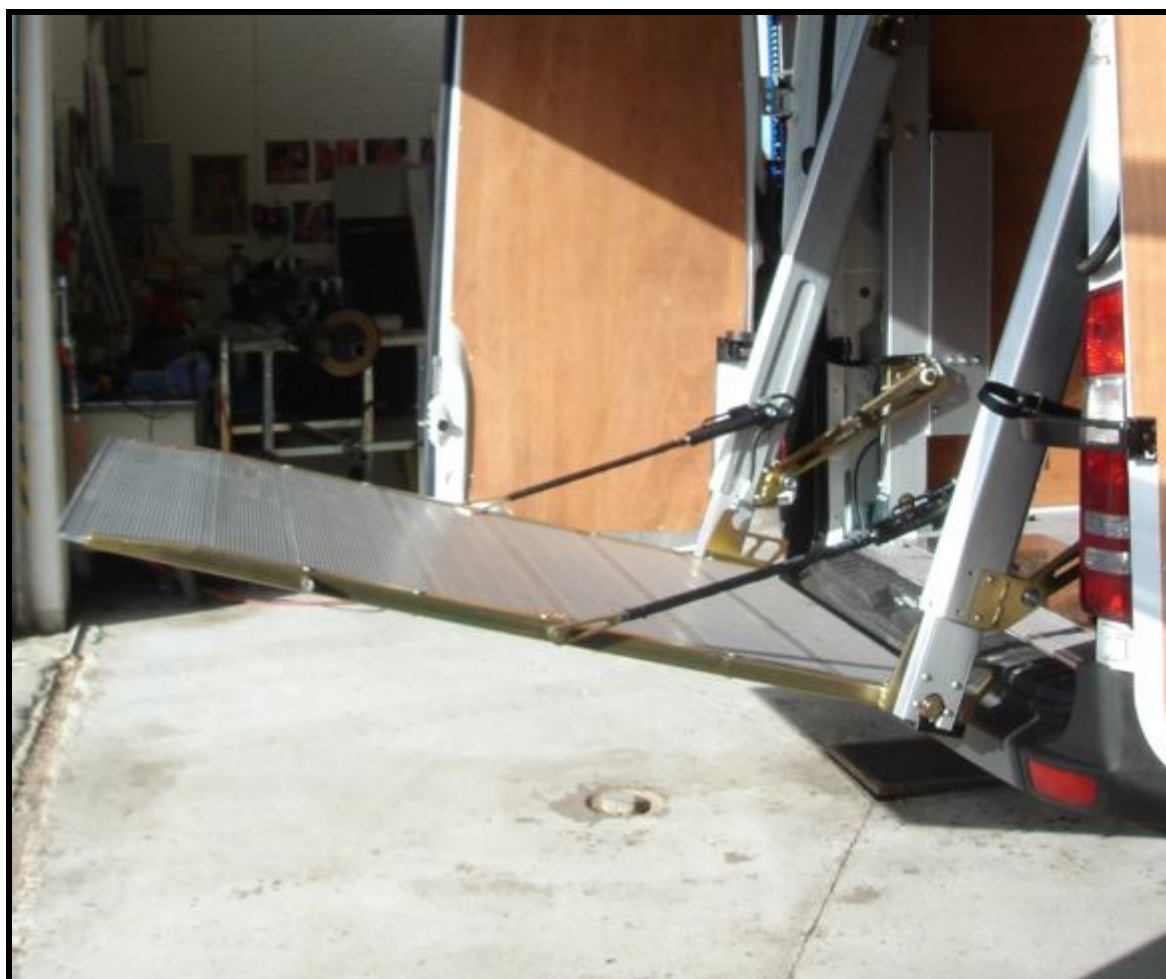
Hydraulisk vip af liftplade (+ 420 mm. / - 100 mm.)
