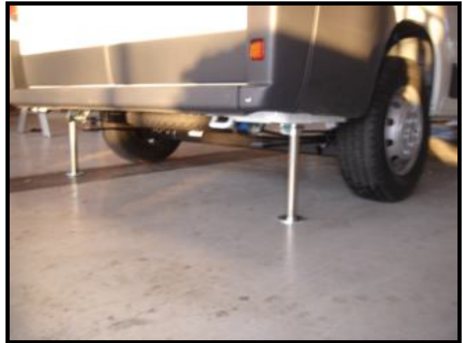
Hydrauliske støtteben forhindrer sammen-sækning ved pålæsning / aflæsning.
